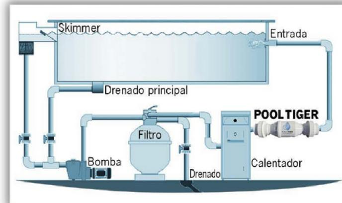
En piscinas nuevas, el Pool Tiger debe instalarse en último lugar en la línea de retorno. En piscinas existentes con calentador, debe instalarse antes del calentador en la línea de retorno. Si la línea de retorno es demasiado corta para instalar el Pool Tiger en línea, realice un by-pass. El Pool Tiger puede instalarse horizontalmente, vertical o diagonalmente.
